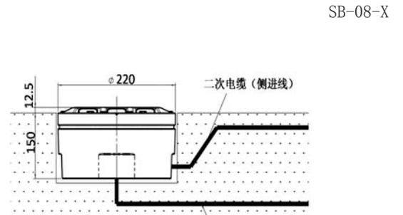
可选择的接线方式：底进线、侧进线
